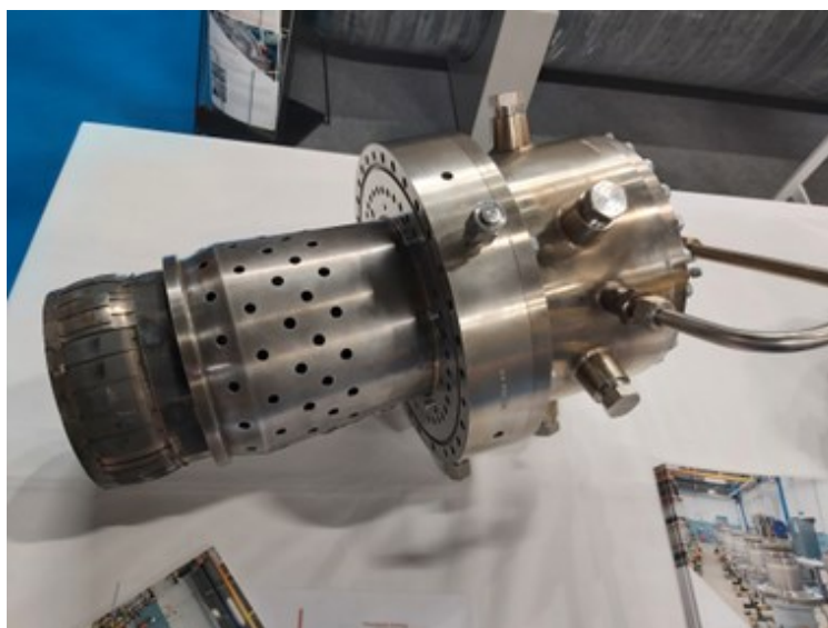
Figuur 7.1 - PSM Flame Sheet Combustor voor retrofit van gasturbines
